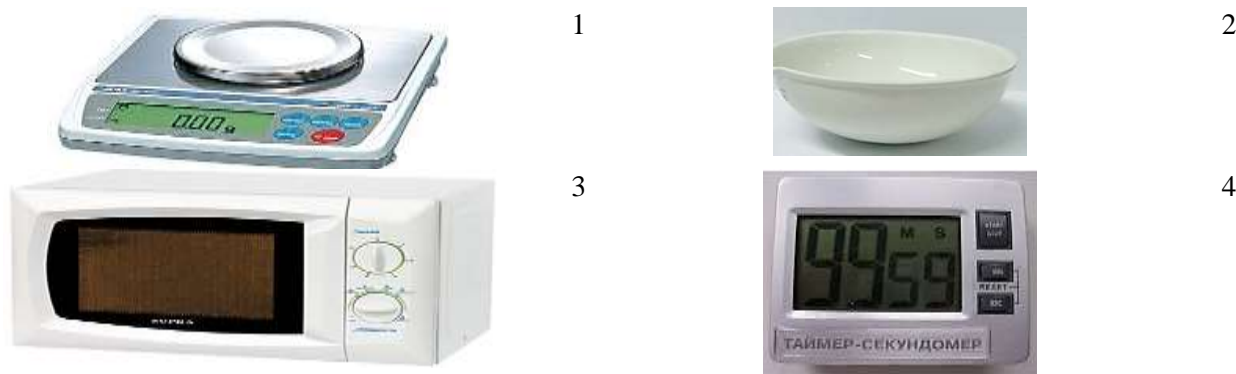
Рисунок 3. Используемые приборы: 1 — весы электронные лабораторные, 2 — чашка лабораторная, 3 — микроволновая печь Supra MWS-1714-700Вт, 4 — часы сигнальные лабораторные
