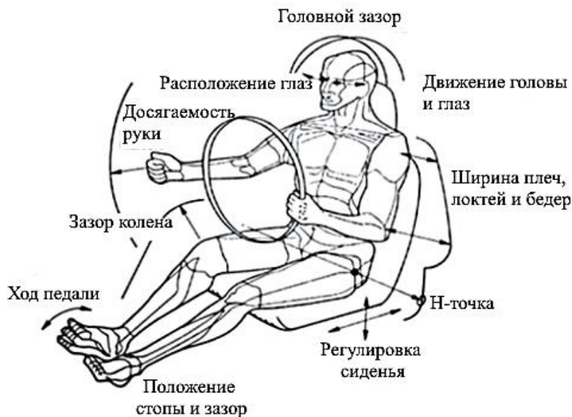
Рисунок 2. Эргономические критерии проектирования адаптированных мест для вождения
