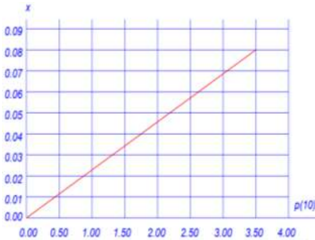
Рисунок 4. Зависимость между траекторией центра мгновенного поворота и положением нейтральной оси по напряжениям
