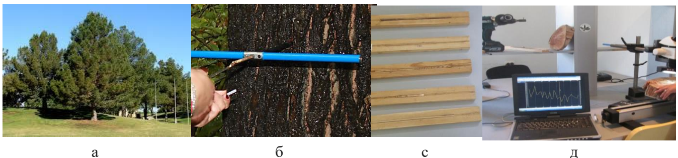
Рисунок 1. Вид Pinus eldarica Medw. (а), взятие образцов из древесины с помощью бура Suunto (б) сушка в контейнерах извлеченных образцов (с) и уточнение их хронологии (д)
