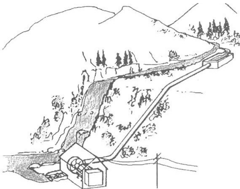
Рисунок 9. Напорная микро ГЭС без деривационного канала
