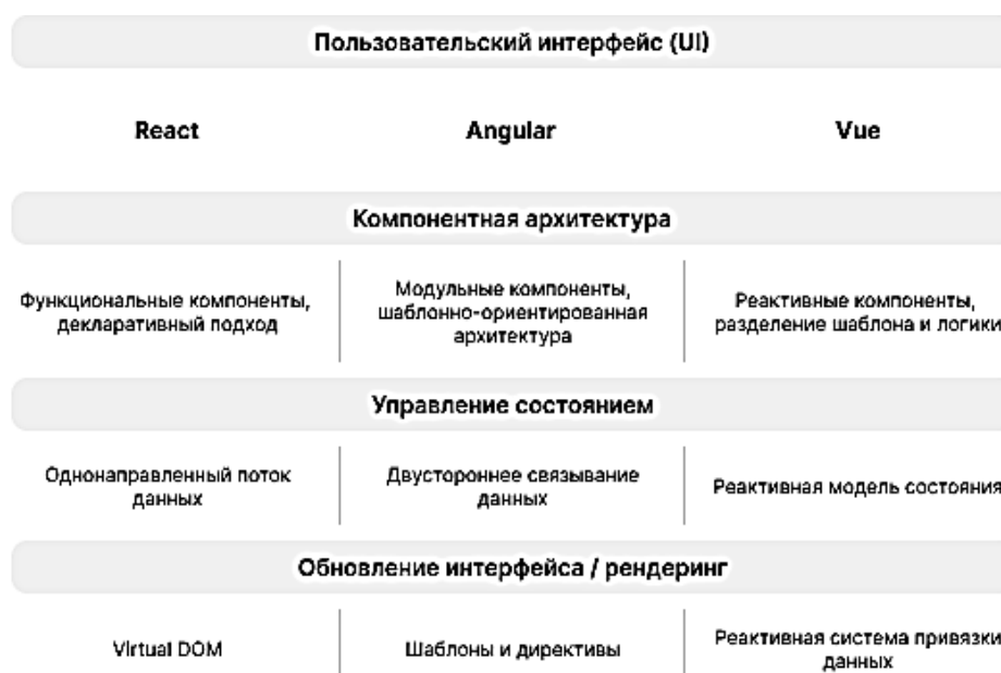
Рисунок. Сравнение архитектурных подходов фронтенд-фреймворков React, Angular и Vue в контексте проектирования пользовательского интерфейса
