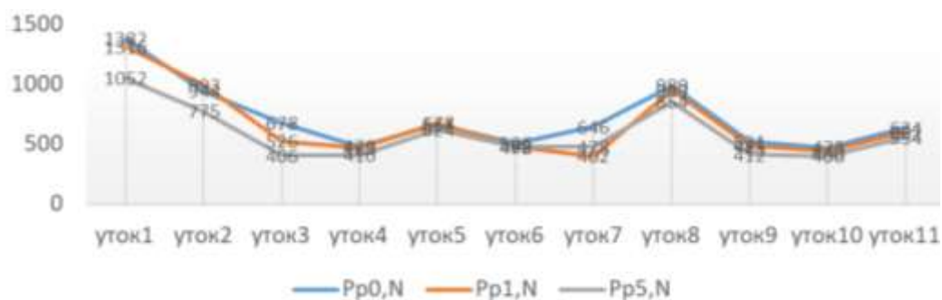
Рисунок 2. Зависимость разрывной нагрузки по утку тканей для внешнего чехла от количества стирок
