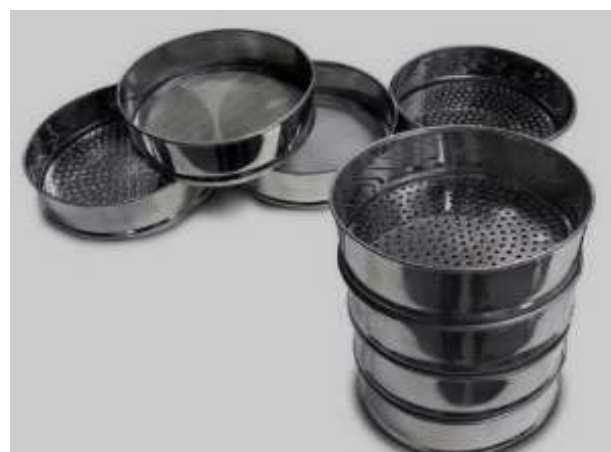
Рисунок 13. Сито с размерами отверстий 5, 2, 1, 0,5, 0,25, 0,1, 0,01 мм
