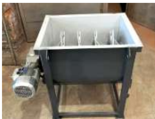
Рисунок 15. Горизонтальный смеситель сыпучих компонентов с 75 об/мин, с рабочей вместимостью до 1,1- 5 м 3 , и мощностью до 1,5- 5,87 кВт
