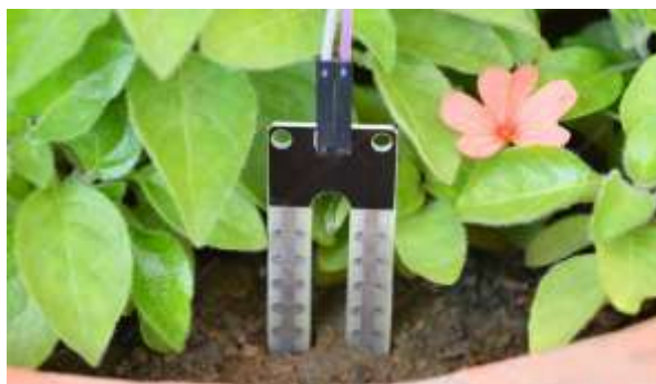
Рисунок 4. Установка датчика влажности на почву
