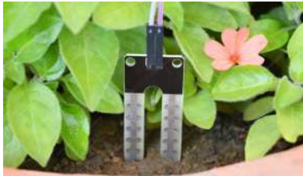
Рисунок 4. Установка датчика влажности на почву
