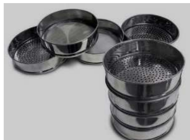
Рисунок 13. Сито с размерами отверстий 5, 2, 1, 0,5, 0,25, 0,1, 0,01 мм
