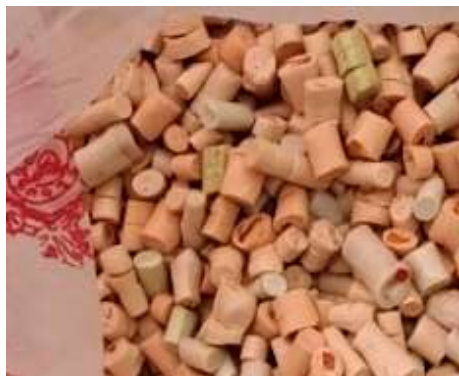
Рисунок 7. Готовое сырье с добавлением пластификаторов, стабилизаторов и красителей в виде гранул
