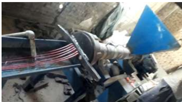
Рисунок 5. Получение расплавленного сырья в виде нитей в при термической обработки в 120-160°C
