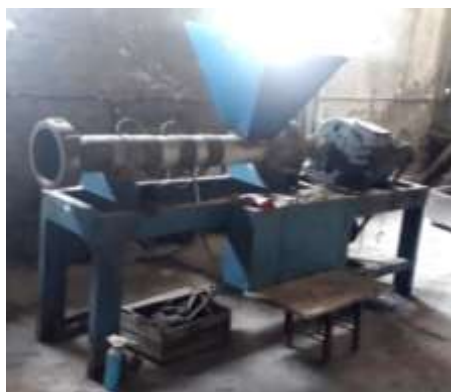
Рисунок 4. Установка для термической обработки отходов полимера и резины
