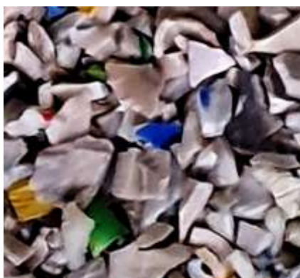
Рисунок 2. Образцы измельченного сырья (размеры образцов сырья составляют 5-6 мм)
