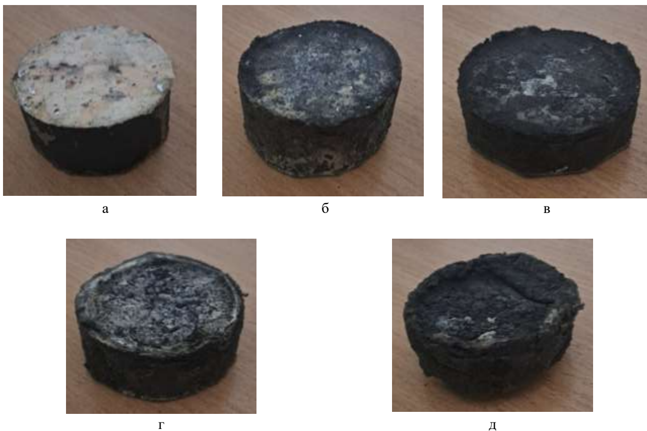
Рисунок 17. Образцы прессованных композиционных материалов на основе полимерных отходов и резины, и базальтовых пород
