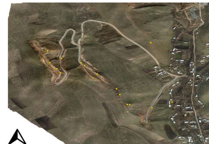
Рисунок 1. Опорные точки установленные с помощью GNSS приемника
