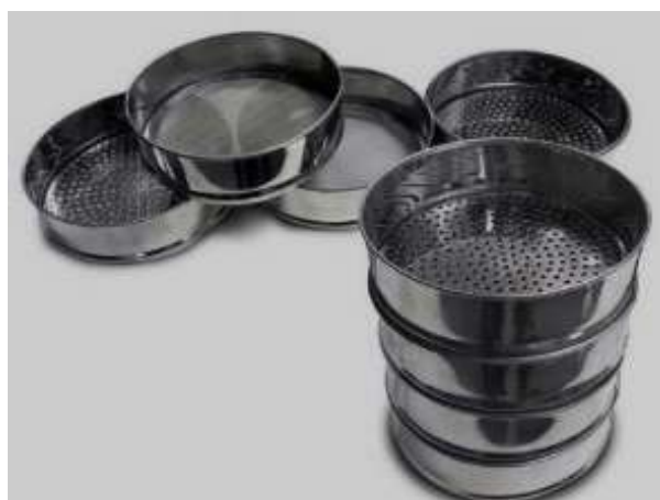
Рисунок 13. Сито с размерами отверстий 5, 2, 1, 0,5, 0,25, 0,1, 0,01 мм
