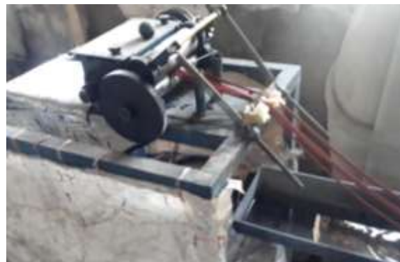
Рисунок 8. Установка для гранулирования обработанного сырья
