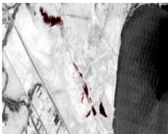
Рисунок 20. Векторизация водной поверхности по NDVI по снимку Landsat8 за 2010 г
