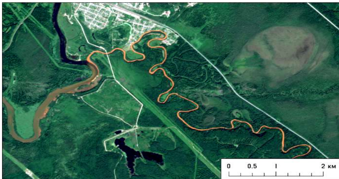
Рисунок 2. Загрязнение реки кислыми водами с высокой концентрацией железа (река в жёлто-оранжевом цвете)
