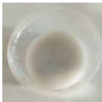
Рисунок 3. Фильтрация электрически активированной воды: а) процесс фильтрации активированной воды; б) белый осадок на дне сосуда.
