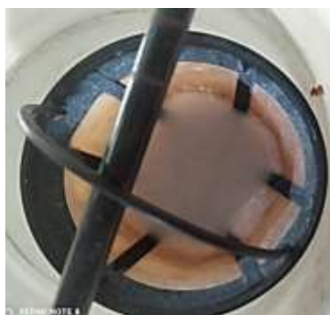
Рисунок 3. Фильтрация электрически активированной воды: а) процесс фильтрации активированной воды; б) белый осадок на дне сосуда.
