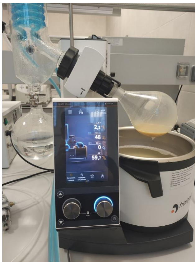
Рисунок 1. Выпаривание экстракта на вакуумном ротационном испарителе
