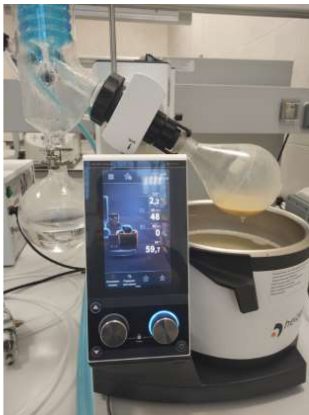
Рисунок 1. Выпаривание экстракта на вакуумном ротационном испарителе
