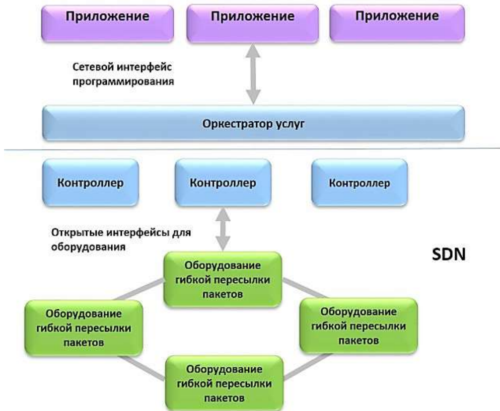
Рисунок. Архитектура SDN и NFV
