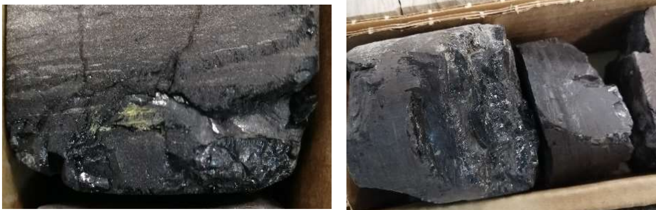
Рисунок 6. Породы марьяновской свиты (скважина Боровая 9) представляют собой битуминозные плитчатые аргиллиты
