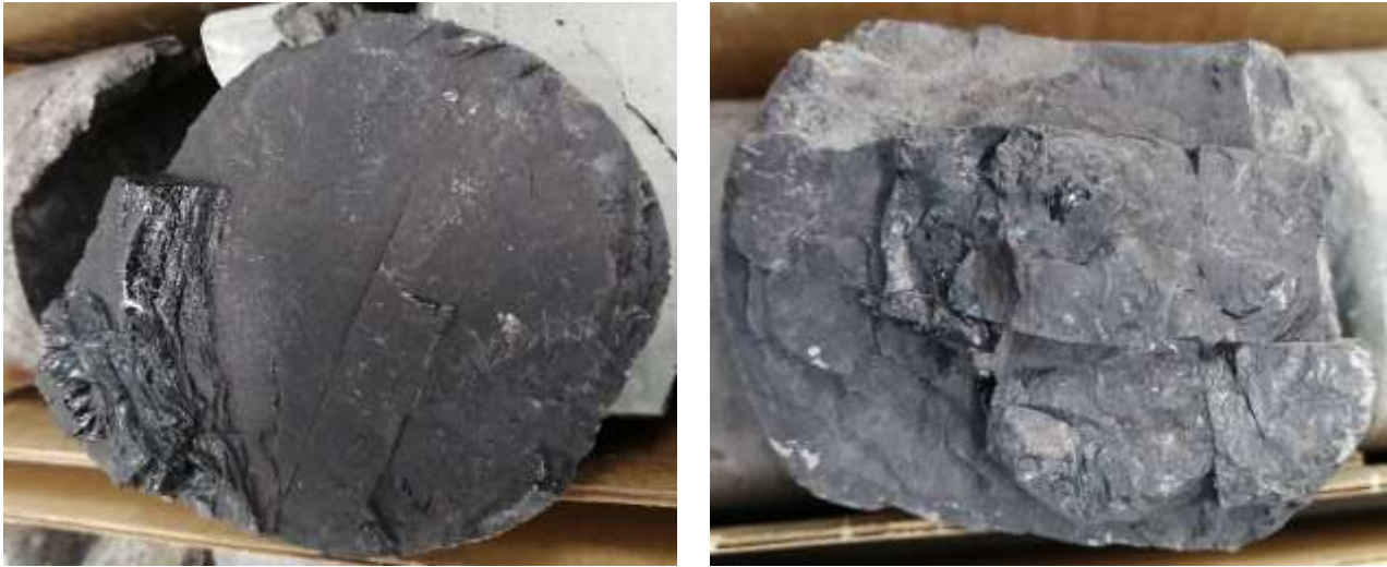
Рисунок 5. Прослои битуминозных аргиллитов в разрезе тюменской свиты (скв. Боровая 7). Аргиллиты темно-серые, крепкие, массивные, с большим содержанием органики.
