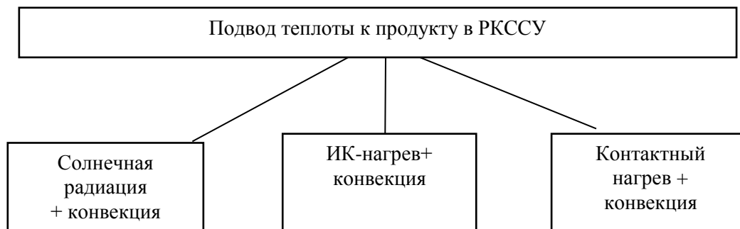
Рисунок 2. Схема подвода теплоты к высушиваемым продуктам в радиационно-конвективной солнечной сушильной установке
