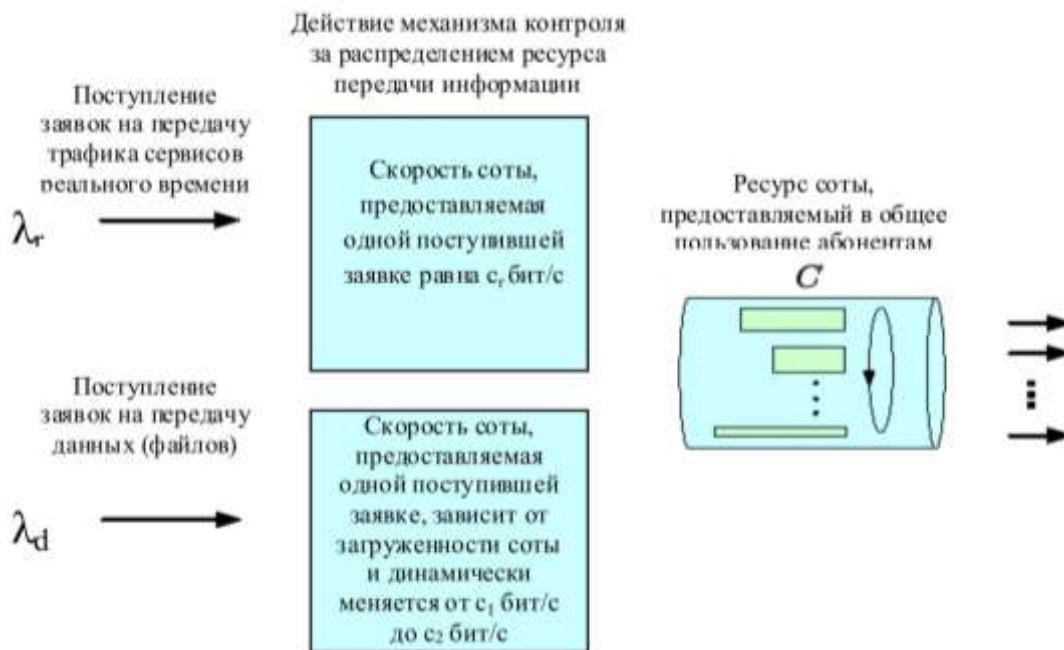
Рисунок 1. Схема функционирования модели фрагмента сети стандарта LTE
